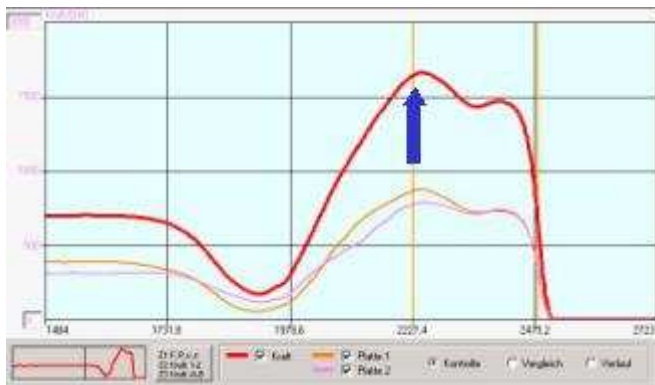
Beschleunigung während eines Sprunges: orange Kurve – linke Seite, rosa Kurve – rechte Seite, rote Kurve - Gesamtbeschleunigung
